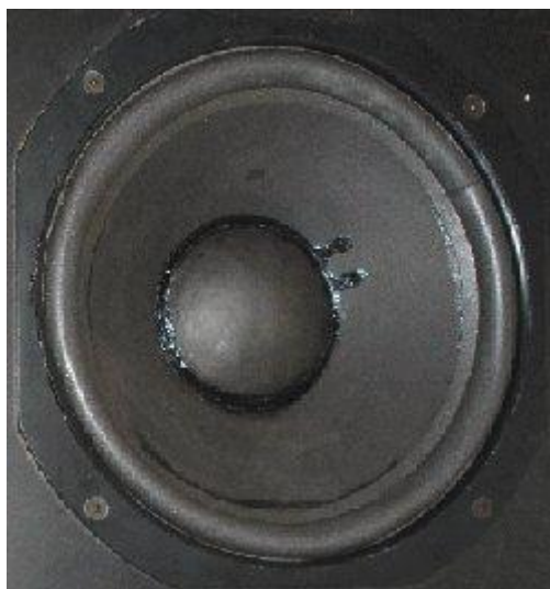
L'altoparlante dopo la riparazione. Montato in cassa è pronto per la prova.
